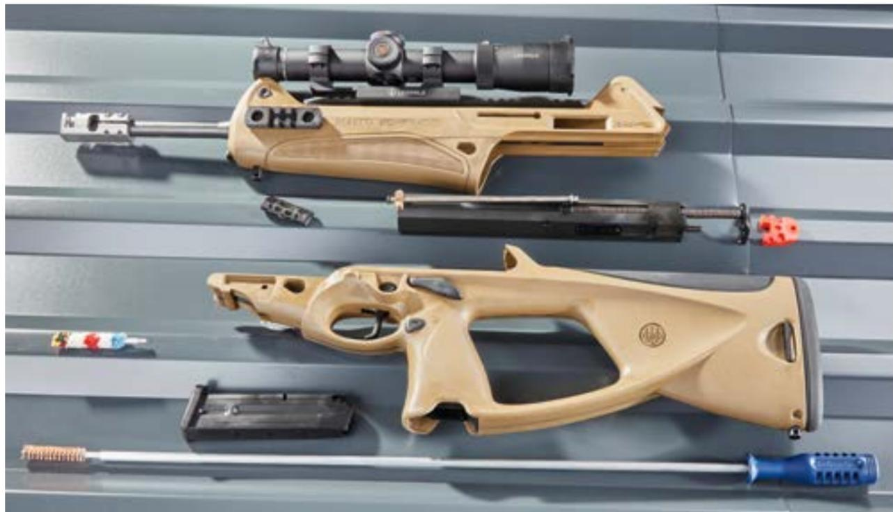
Der Cx4 Storm ist werkzeuglos in Sekunden zerlegt. Nicht eingebaut, auf dem Verschluss: die Tectal-Federführungsstange aus Metall statt Kunststoff mit rotem Puffer (97 Euro). Toll: Der stabile Putzstock im Lieferumfang hat einen mitdrehenden Griff.
