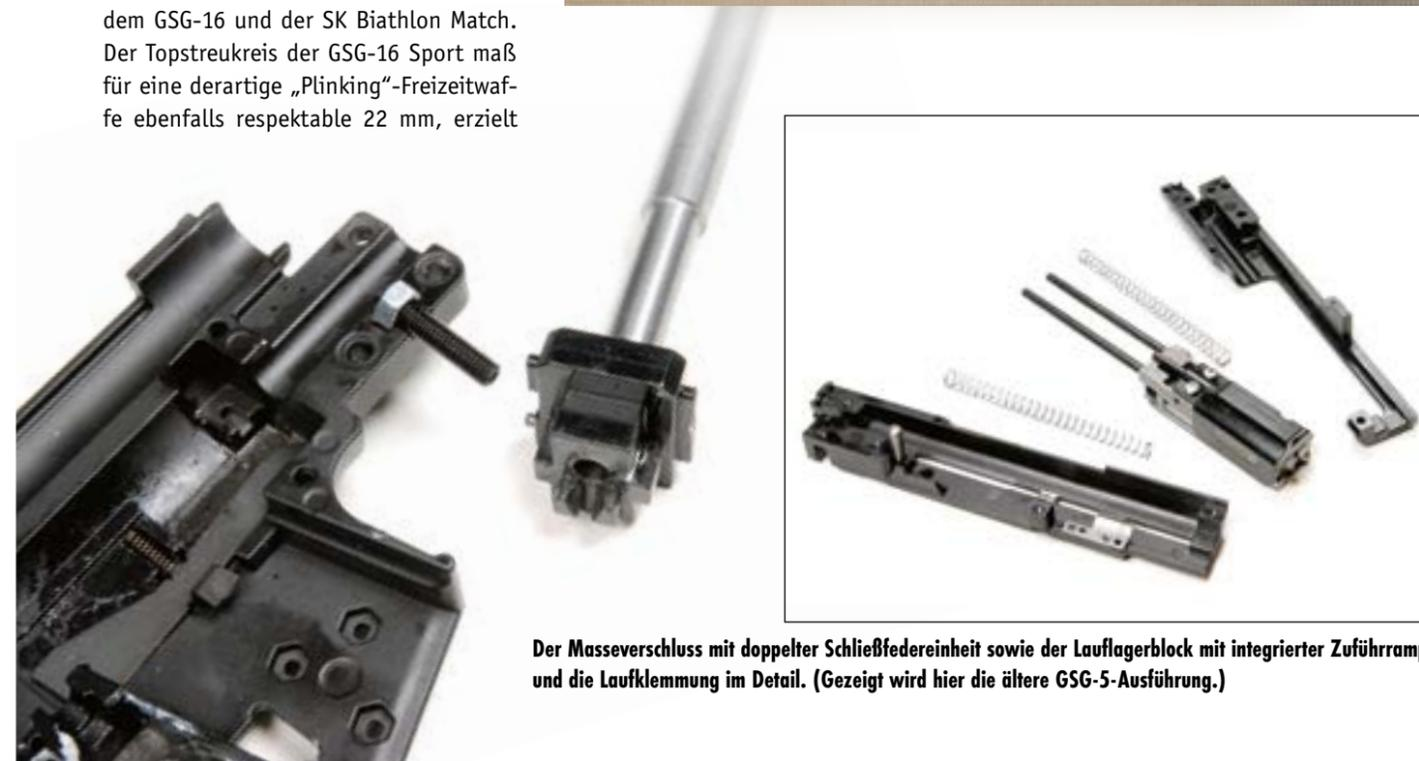
Der Masseverschluss mit doppelter Schließfedereinheit sowie der Laufflagerblock mit integrierter Zuführrampe und die Laufklemmung im Detail. (Gezeigt wird hier die ältere GSG-5-Ausführung.)
