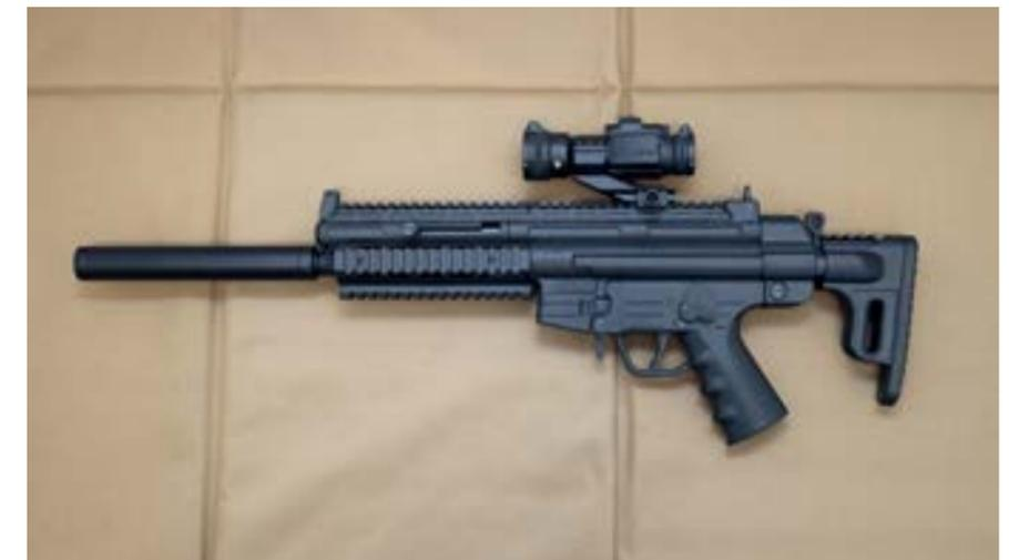
der Standardvariante mit einem Durchschnittswert von 2.468 Gramm. Dieses Modell besitzt eine Magazinsicherung, sodass der Abzug nur bei eingesetztem Patronencontainer auslöst.
