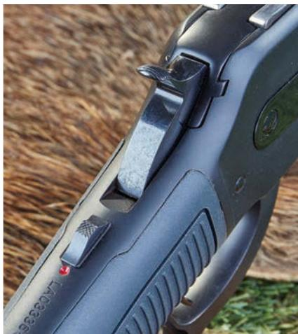
Steht der Sicherungsschieber auf dem Kolbenhals hinten, sind Hahn, Abzug und Lever blockiert, steht er vorn auf Rot, ist die Büchse schussbereit.
