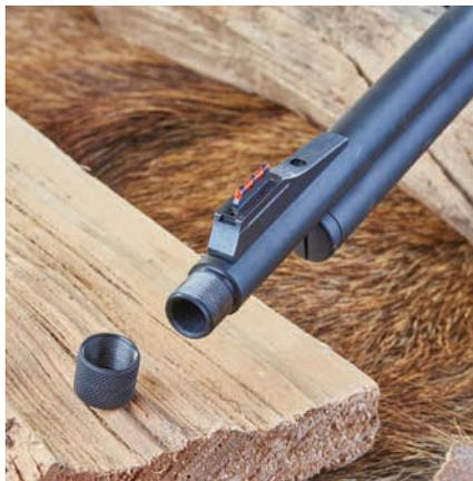
Über dem Mündungsgewinde gibt es einen Kornsockel mit einem roten Lichtsammlerstab und Schlitzaufnahmen für ein Korntunnelgehäuse.
