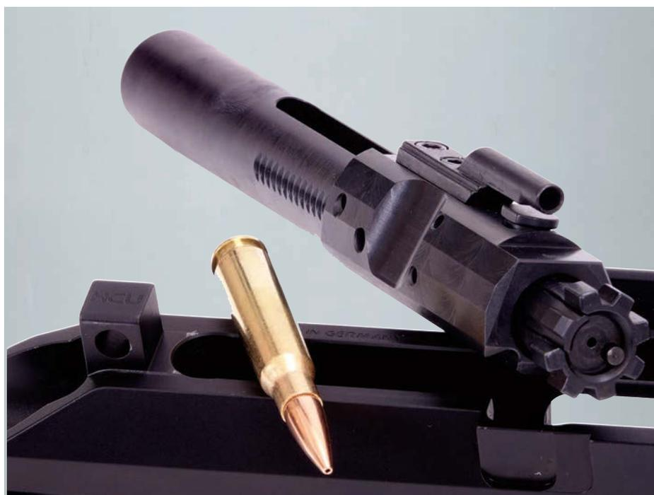
Die Verschlussgruppen aller 7SIX2-Modelle werden in einer Magnetpulverprüfung auf Risse inspiziert (MPI; Magnetic Particle Inspection), nach militärischen Spezifikationen verdichtet sowie nitriert.
