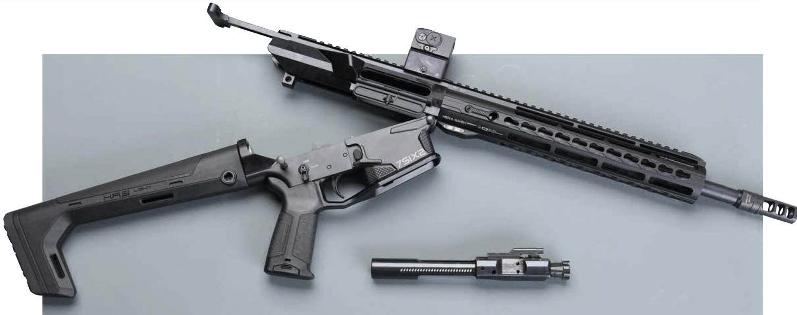
Das aufgeklappte HERA Arms 7SIX2 1020 mit herausgenommenem Verschlussträger. Die Bohrung für die vordere Griffstück-Drehachse wurde am Systemgehäuse asymmetrisch gesetzt. So treffen beim Aufklappen der Waffe Lower und Upper nicht mit Wucht aufeinander, was unschöne Macken verhindert.
