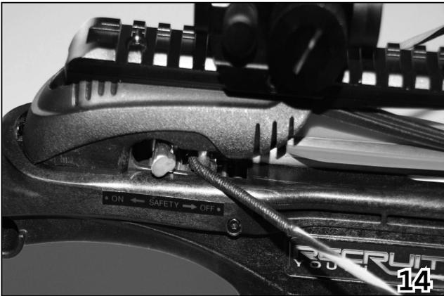
Die Armbrust ist gespannt und der Pfeil liegt an der Sehne an (Bild 14). Der Sicherungshebel kann nun manuell auf die „Fire“- Position gewechselt werden. Achtung! Die Armbrust ist nun gespannt und geladen. Entsichern Sie die Armbrust nur, wenn Sie für den Schuss bereit sind und die nötigen Sicherheitsmaßnahmen getroffen haben!
