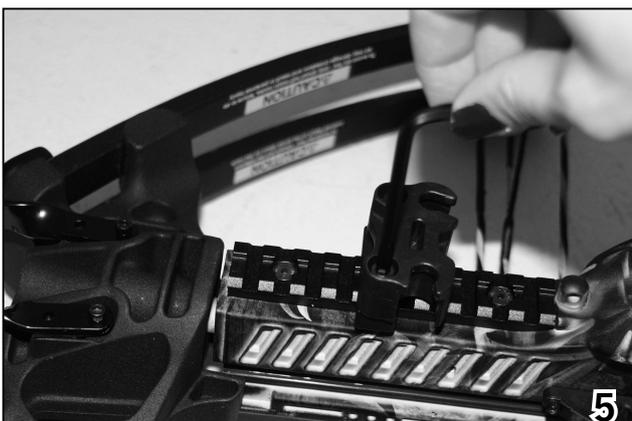
5. Um den Montageköcher (3a) zu montieren, drehen Sie zuerst die Schraube am Anbauteil des Köchers (3b) etwas locker. Schieben Sie es anschließend auf die Weaverschiene an der Unterseite des Schaftes auf. Befestigen Sie das Anbauteil in beliebiger Position durch festdrehen der eben gelockerten Schraube.
