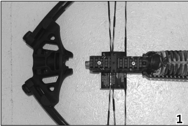
1. Schieben Sie den Armbrustbogen (2) auf das vordere Schaftende (1a) auf, so dass eine formschlüssige Verbindung entsteht. Die Sehne (2b) liegt dabei auf der Schaftoberseite auf, die Kabel (2a) befinden sich im Kabelschlitz.
