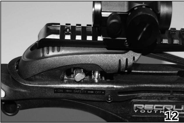
Stellung vor dem Spannvorgang (Bild 12). Der Sicherungshebel befindet sich rechts auf der „Fire“- Position (SAFETY OFF). Der Abzug lässt sich betätigen und die Armbrust ist zur Sehnenaufnahme bereit.
