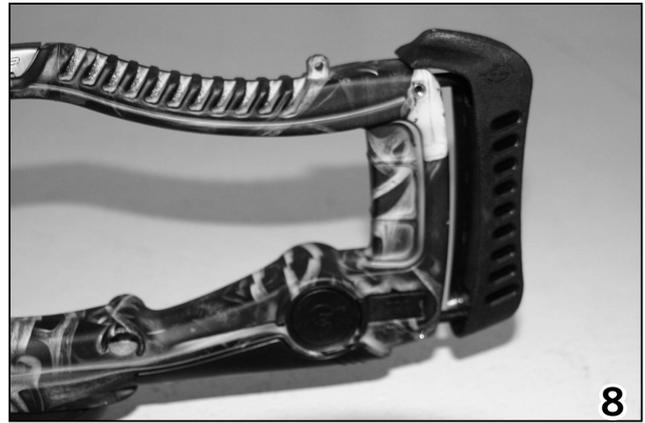
Durch lösen der Schrauben am Anlageschaft kann dieser verstellt werden. Nach der Verstellung sind die Schrauben wieder zu befestigen.
