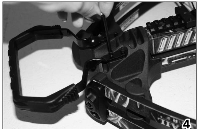
4. Legen Sie nun den Fußbügel über die Dämpfer und befestigen Sie ihn mit den zugehörigen Schrauben handfest.
