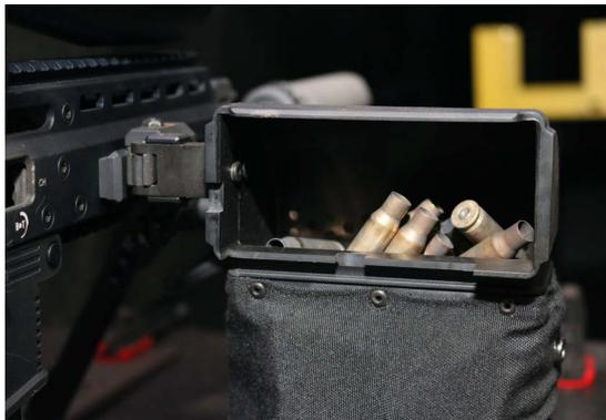
B & T bietet einen Hülsenfangsack an, der sich rechts an der APC308 montieren und der sich auch abklappen lässt.
