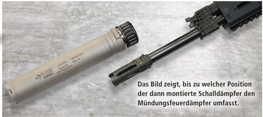
schlussrücklaufgeschwindigkeit. Dann treten Auswurfstörungen auf. Dieses Problem gibt es übrigens bei jedem Halbautomaten in Verbindung mit einem Schalldämpfer. Kurzfristig hilft ein Sprühstoß dünnflüssiges Waffenöl auf die beweglichen Teile. Aus Sicht der Tester sollte die Waffe bei SD-Betrieb alle 80 bis 100 Schuss im Bereich des Verschlussblockes und der Führungen gereinigt werden.
