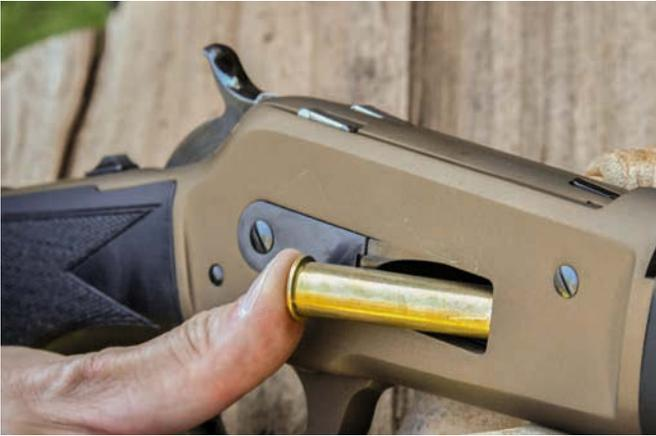
**Seitenlader:** Jede einzelne Patrone muss in das Röhrenmagazin seitlich eingeschoben werden. Der Test-UHR fasst fünf Schuss.
