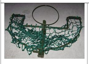
4. Entsichern Sie die Falle durch Schieben des L-förmigen Riegels (hinten) nach außen (weg vom Bügel).
