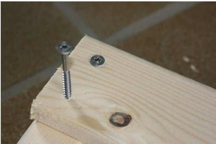
Um das Aufplatzen der Hölzer beim Verschrauben zu vermeiden, wird das Vorbohren der Schraubenlöcher dringend empfohlen.
