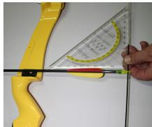
2. Mittels Hilfsmittel (Dreieck) bilden Sie nun einen rechten Winkel von 90° Grad an der Sehne und richten Sie den Pfeil exakt nach diesem Winkel aus. Markieren Sie die Stelle, an dem der rechte Winkel an der Sehne liegt.
