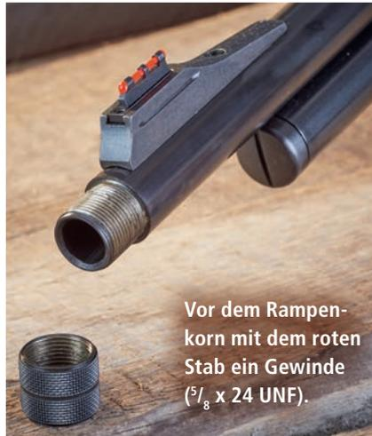
Vor dem Rampenkorn mit dem roten Stab ein Gewinde ( $\frac{5}{8} \times 24$  UNF).
