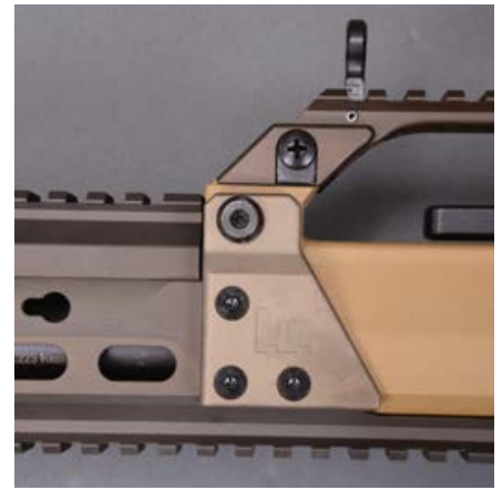
Kunststoff-Handschutz des HK 243 SAR (oben) und Leichtmetall-Handschutz des TAR (unten) im Vergleich. Detail der bombenfesten Handschutz-Aufnahme am Systemgehäuse des TAR.
