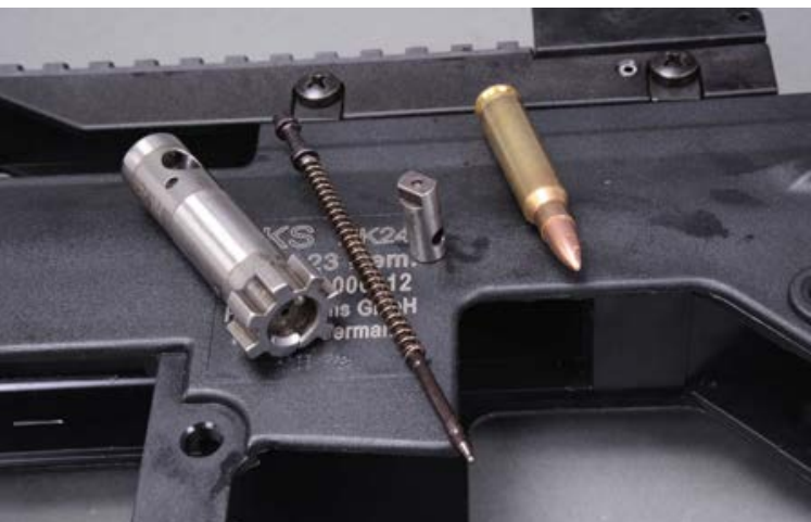
Der Drehkopf-Verschluss mit sechs Warzen im Detail.
