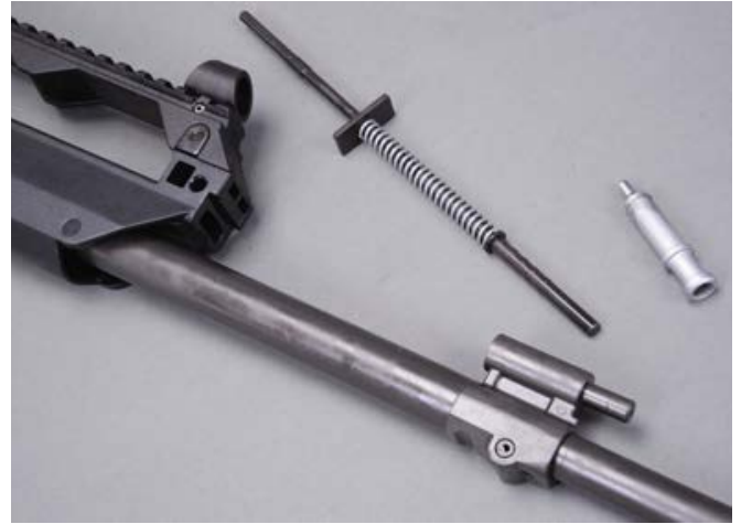
Blick unter den Handschutz: Das indirekte Kurzhub-Gaskolben-System („short stroke system“) im montierten und ausgebauten Zustand.
