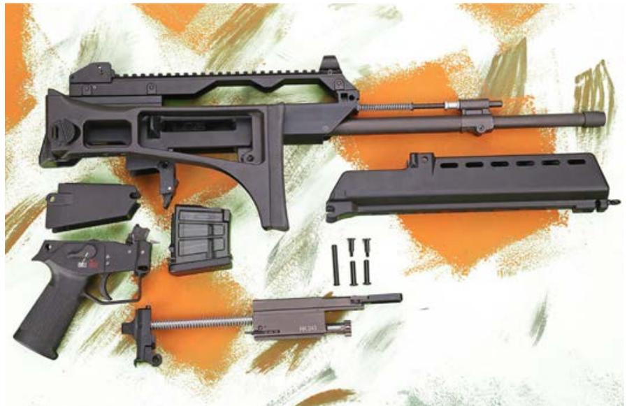
Technisch orientiert sich das HK 243 am G 36. Für die Demontage braucht es aber aufgrund der zweiteiligen Gehäuseschrauben zwei Inbusschlüssel gleicher Größe. Zumindest den Testwaffen lag aber keinerlei Werkzeug bei.
