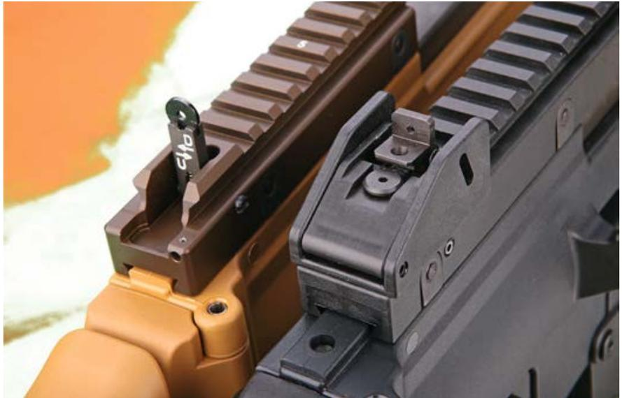
Heckler & Koch bietet für das G36/HK243 diverse Montageschienen aus Kunststoff oder Dural an. Werksmäßig kommt das S-TAR (links) mit einer Aluschiene und integrierter Stahlvisierung zum Aufklappen, während man sich beim S-SAR mit einer Polymerschienen begnügen muss.
